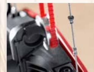
Die einzigartigen Schneidglieder des Sägeseis wurden speziell so konstruiert, dass sie in alle Richtungen schneiden können. Das Spezialwerkzeug ist jeweils mit 23 Säge- und Antriebsgliedern ausgestattet.
