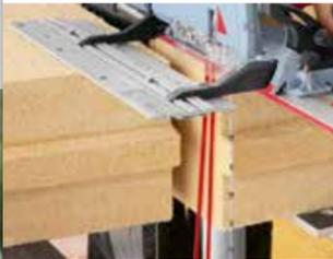
Dank dem perfekten Zusammenspiel aller Systemkomponenten und den innovativen Detaillösungen wie Sägeseil, Carbon-Führungskeil und Späneräumer wird eine hoch-präzise Schnittqualität erzielt.
