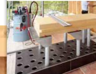
Egal ob Längs-, Quer- oder Schrägschnitt: Das steckbare System für druckfeste und flexible Dämmstoffe kann individuell an jede Schnittsituation angepasst werden. Auch auf dem Gerüst.
